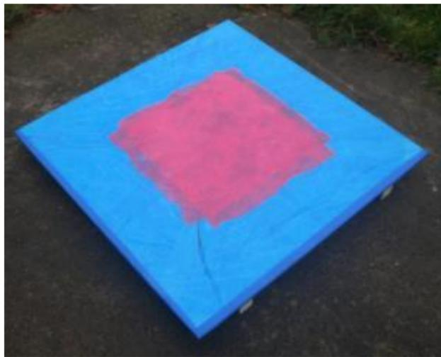
Diese **Platte mit dem geplanten Aufbau** ist fast 1 m<sup>2</sup> groß und liegt jetzt seit Anfang Nov. draußen und ist damit der Witterung ausgesetzt – ein echter Langzeittest ist möglich.
